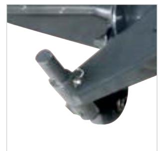
**ROUES DE JAUGE CAOUTCHOUC MONTÉES SUR GRAISSEUR**
