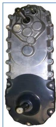
**Boite de vitesses** dotée de **2 vitesses avant et 1 vitesse arrière**.
