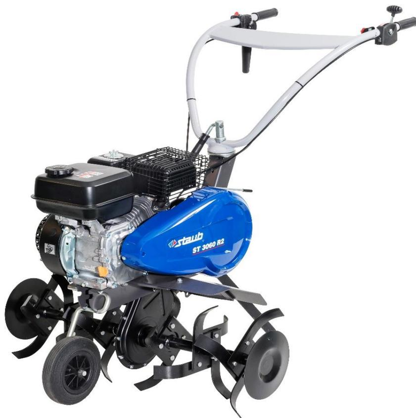
La motobineuse **ST 3060 R2** est une motobineuse robuste, polyvalente et efficace qui permet de réaliser différents travaux dans votre potager. Cette machine compacte est équipée d'une boîte de vitesse avec des pignons en acier. Elle possède **2 vitesses avant**, chacune étagée pour être adaptée à 2 fonctions :
