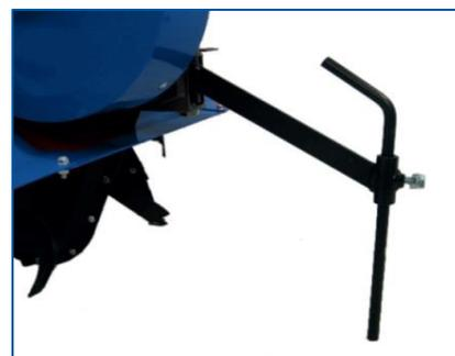
**Kit roue arrière + pic de terrage.**
