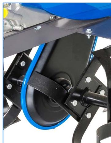
La commande au guidon agit sur le boîtier qui permet **d'inverser le sens de rotation des fraises**.
