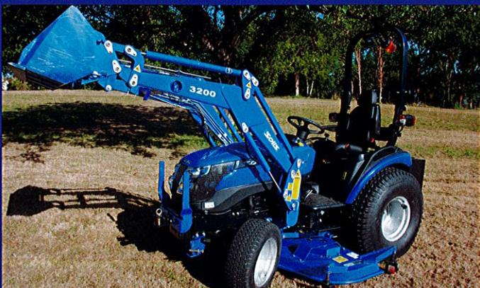
Option chargeur frontal, tondeuse ventrale avec relevage hydraulique, roue gazon, agraire, mixte.
