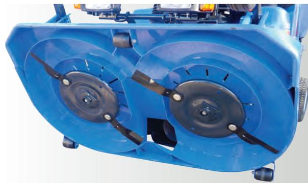
La ventilation des plateaux de coupe (photo SF2152) est assurée par des ouïes entourées d'une ceinture inférieure située autour des paliers. Ce système permet de relever l'herbe qui est immédiatement coupée.
