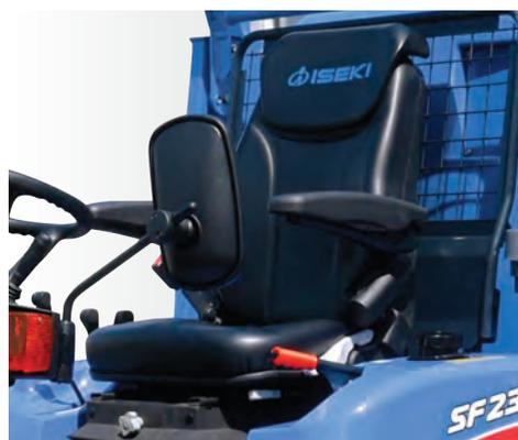
Le siège à suspension mécanique réglable peut s'avancer et se reculer. Il intègre un dossier inclinable, un appui-tête extensible, des accoudoirs à inclinaison modulable et une ceinture de sécurité.
