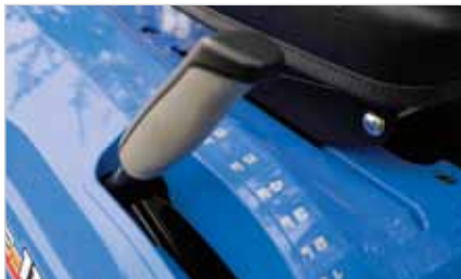
Réglage centralisé de la hauteur de coupe assisté par ressort
