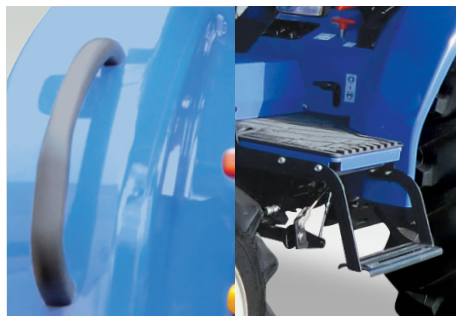
Poignée ergonomique et marchepied large pour faciliter l'accès à la plateforme
