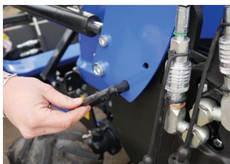
Attelage/déttelage instantané chargeur/tracteur Verrouillage par broche, simple et rapide.
