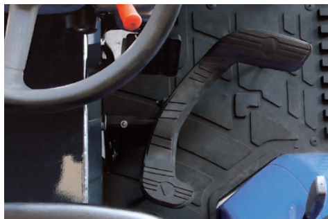
Monopédale HST confortable, avancé en souplesse (TLE3400)
