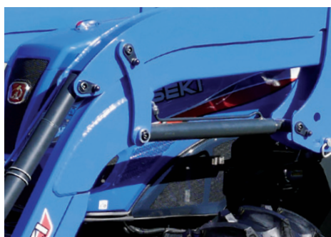
Entretien simplifié : Articulations montées sur graisseurs.
