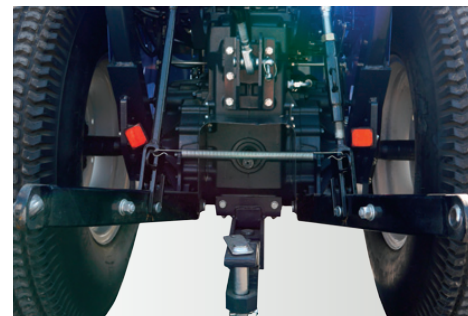
Relevage arrière robuste d'une capacité de 1 000 kg pour le TLE3400 et 1 200 kg pour le TLE4490
