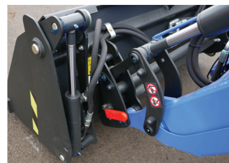
Attelage automatique chargeur/outil* Le déverrouillage s'effectue simplement à l'aide d'un levier facile d'accès.
