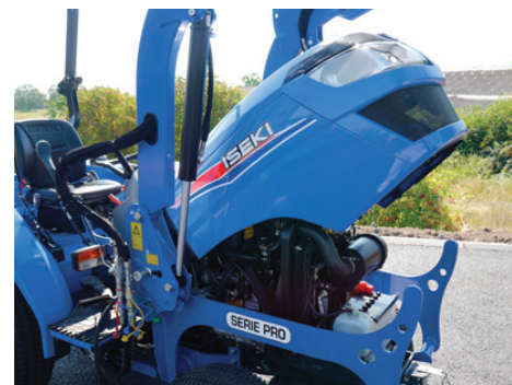
Ouverture monobloc du capot pour un entretien simplifié (TLE4490)
