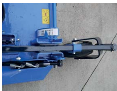
RÉGLAGE DE LA HAUTEUR DE COUPE HYDRAULIQUE DEPUIS LE POSTE DE CONDUITE (OPTION)
