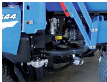
ACCÈS AISÉ AU FILTRE À HUILE, À LA BATTERIE, ET AU FILTRE À GASOIL.
