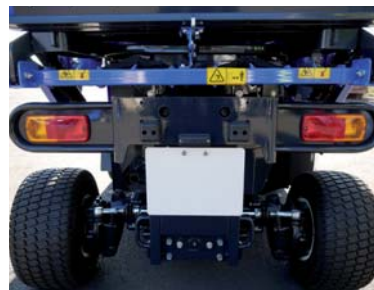
PONT ARRIÈRE TRÈS ROBUSTE AVEC RENVOIS D'ANGLE EN FONTE
