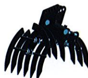
Grappin avec contrepoids de 30 kg
