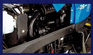
Puissant moteur diesel Mistubishi 3 cylindres, 1318 cm³ pour une puissance réelle de 24 CV et 18 Kw.
