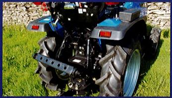
Tout est d'origine : arceau de sécurité, barre à trous, crochet d'attelage AV et AR, distributeur hydraulique double effet, prise remorque, feux de travail AR, gyrophare, contrepoids AV.
