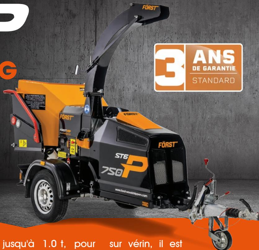
Le ST6P FÖRST est un broyeur de branches essence, avec un diamètre admissible de 150 mm. Ses 37 CV et son couple élevé lui garantit une capacité de broyage équivalente aux moteurs diesel. De fabrication robuste, son châssis AL-KO peut
