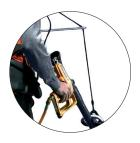
Equilibreur sur pivot permettant un mouvement de balayage
