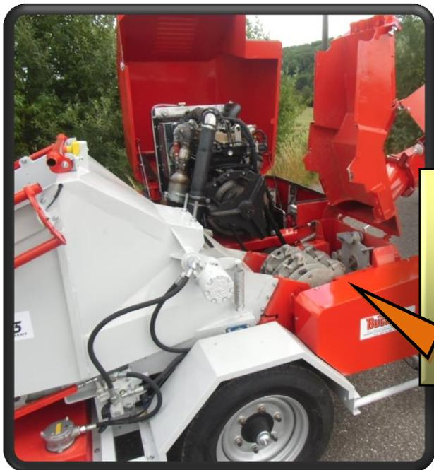
Accès très facile au rotor, au tapis et à la contre-lame par simple basculement de l'éjection
