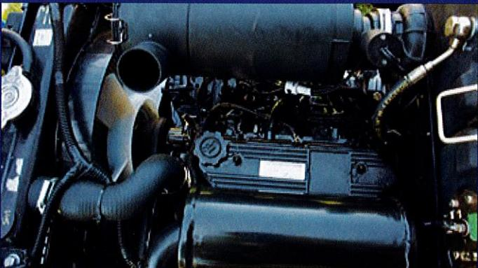
Moteur Mitsubishi diesel 950 cm<sup>3</sup> à refroidissement liquide, 3 cylindres et doté d'une filtration exceptionnelle. D'une grande accessibilité grâce à son capot basculant sur l'arrière.
