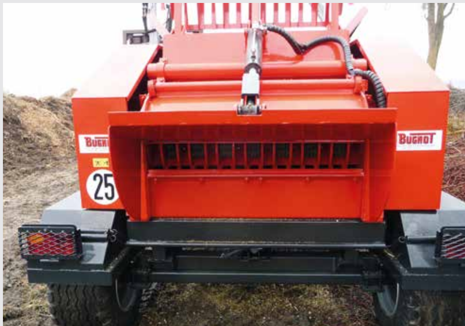
► Essieu freiné et homologation agraire pour transport sur route
